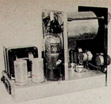
Bild 5. Innenansicht: Die vordere Röhre ECC 40 wurde entfernt, um das elektrisch günstige zwischen den beiden Röhrenfassungen angeordnete Tandempotentiometer zu zeigen
